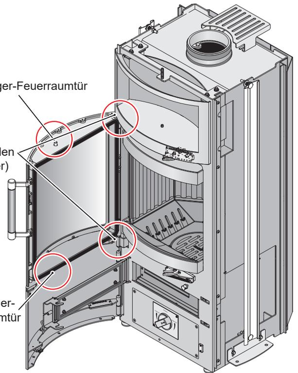
**Achtung:** Überschüssiges Schmiermittel kann herunterlaufen und auf dem Ofenlack dauerhafte Verfärbungen hinterlassen!
