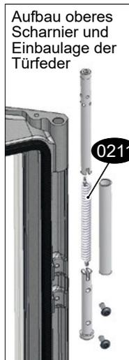
Aufbau oberes Scharnier und Einbaulage der Türfeder
