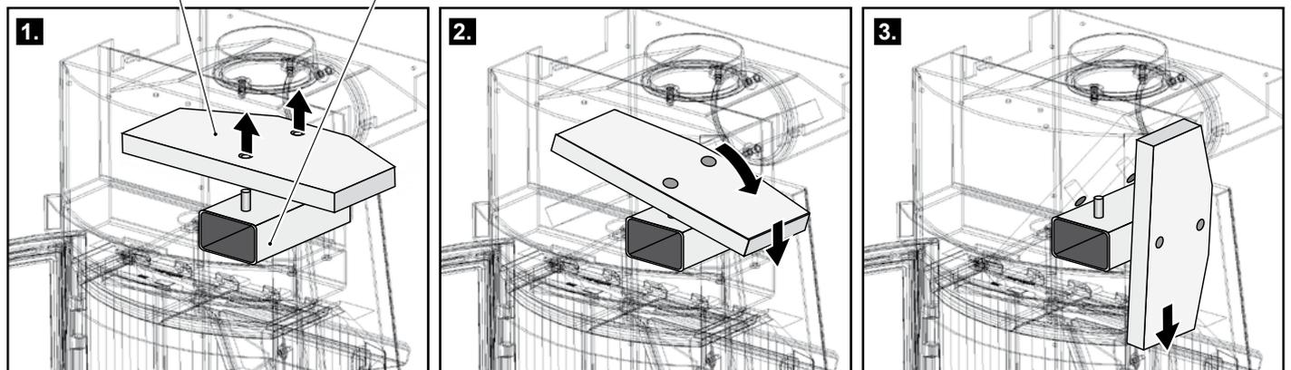
Die Bolzen des Luftkanals greifen in die Bohrungen der oberen Heizgasumlenkplatte.
