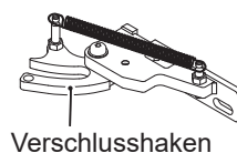
Teile der Feuerraumtürverriegelung (Schloss)
