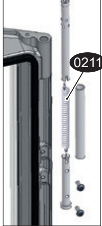
Aufbau oberes Scharnier und Einbaulage der Türfeder
