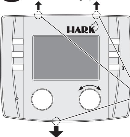
im Bereich dieser drei Punkte ist das Bedienteil mit seiner Trägerplatte verklammert. Zum Abnehmen des Bedienteils diese Punkte nach außen ziehen.
